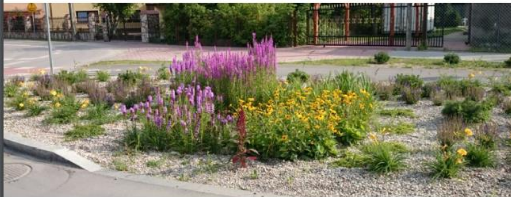
Łąka infiltrująca w Markach – przykład ogrodu deszczowego oczyszczającego wodę z pobliskich dróg, chodnika i Ścieżki rowerowej. Realizacja Fundacja Sendzimira
